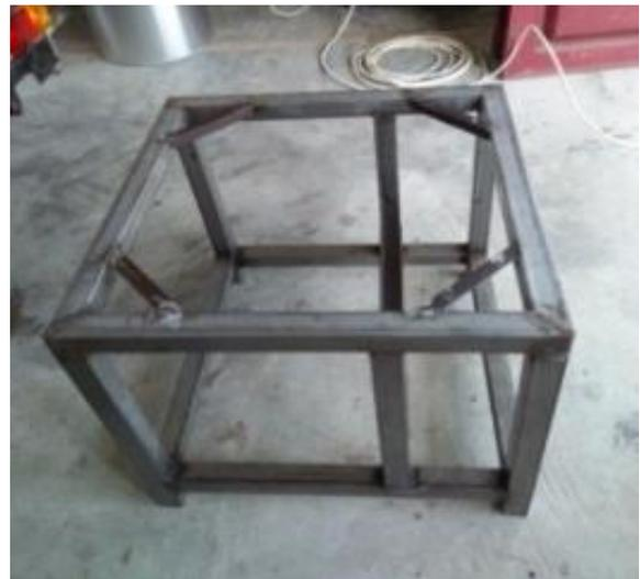
**Gambar 3.** Komponen rangka dudukan mesin
