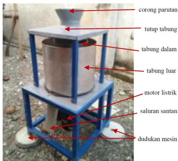
**Gambar 10.** Hasil Akhir Manufaktur Mesin produksi santan sistem Sentrifugal
